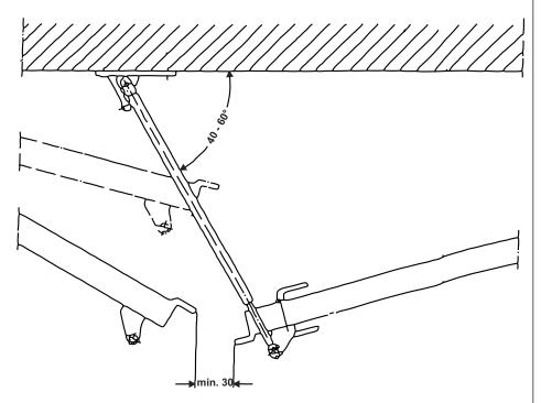
Nachdem beide Türflügel geöffnet wurden, muss sich der Gangflügel so lange am Teleskopgestänge abstützen, bis der Standflügel vorbeigeglitten ist. Der Standflügel nimmt nun mit seinem Stützwinkel das Teleskopgestänge mit und legt es flach an die Zarge. Jetzt kann der Gangflügel folgen und in der richtigen Reihenfolge schließen.
