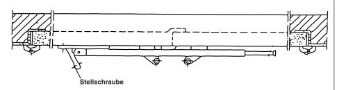
Zuerst werden die Stützwinkel an der Oberkante der beiden Türflügel angebracht
