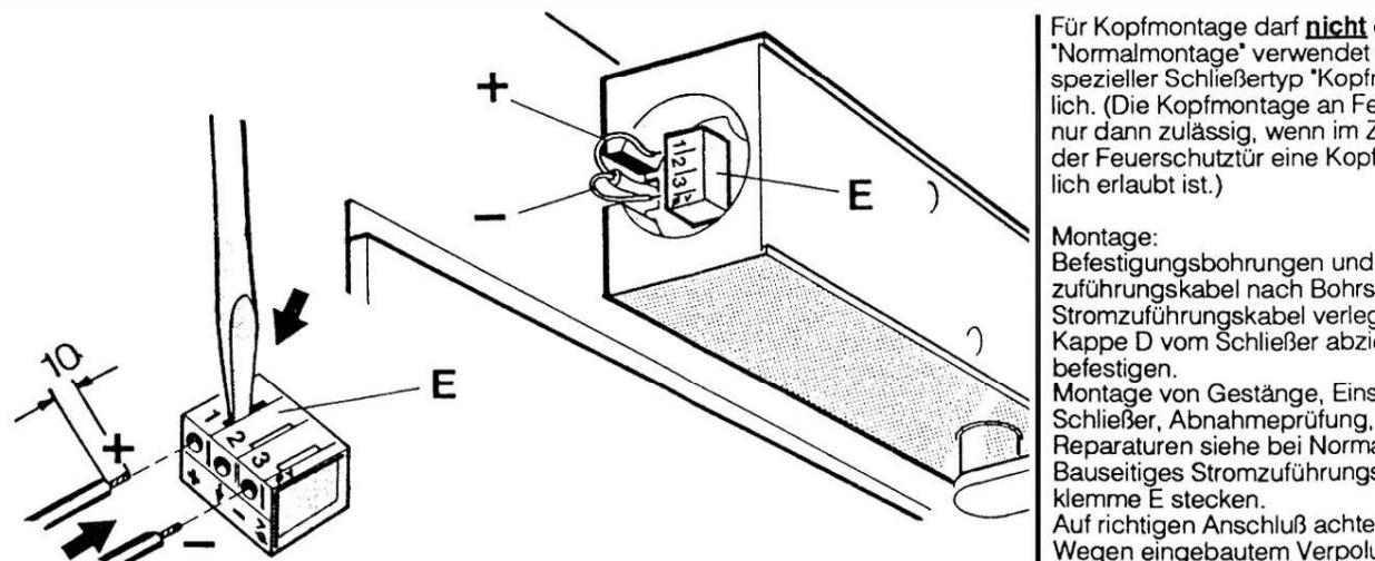
Für Kopfmontage darf **nicht** der Schließertyp "Normalmontage" verwendet werden. Es ist ein spezieller Schließertyp "Kopfmontage" erforderlich. (Die Kopfmontage an Feuerschutztüren ist nur dann zulässig, wenn im Zulassungsbescheid der Feuerschutztür eine Kopfmontage ausdrücklich erlaubt ist.)
