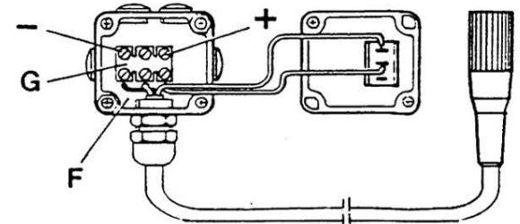
Bauseitiges Stromzuführungskabel zum Anschlußkasten F verlegen und an Lüsterklemme G anschließen. Auf richtigen Anschluß achten! Stecker in Steckbuchse C am Schließer stecken und festschrauben. Wegen eingebautem Verpolungsschutz keine Funktion nach Falschanschluß.
